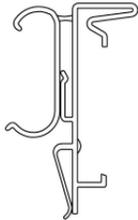
Fixierung des ESL direkt in der Leiste. Mit Flex-Dach zum Schutz des ESL gegen Schmutz und Einwirkung von oben. Mit rückseitiger Klemmung zur Befestigung eines Werbestoppers etc.
