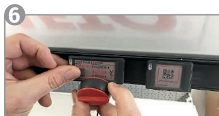
**6** Platzieren Sie den EasyLock Magneten horizontal unterhalb der Pin Position. Bewegen Sie den Magneten leicht hin und her, bis sich der Pin nach unten bewegt.
