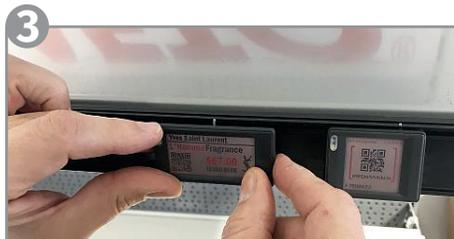
**3** Setzen Sie dann das EasyLock ESL mit dem Metall Pin in die Leiste und justieren es bis der Pin in die Löcher der Leiste einrastet.
