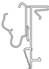
Fixierung des ESL direkt in der Leiste. Mit Flex-Dach zum Schutz des ESL gegen Schmutz und Einwirkung von oben. Mit rückseitiger Klemmung zur Befestigung eines Werbestoppers etc. 2-fach verstellbar
