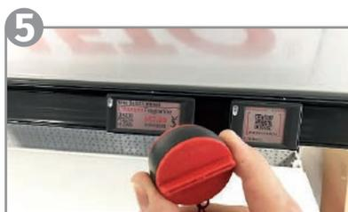
**5** Um das EasyLock ESL zu entfernen nutzen Sie immer den EasyLock Magneten!
